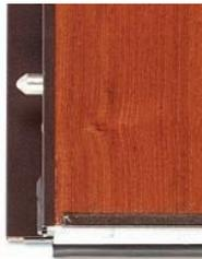
São 4 pernos feitos em aço de 15mm de diâmetro que ficam colocados no mesmo lado das dobradiças. Impossibilitam o arrombamento da porta com um pé de cabra, deixando-a ancorada no seu alojamento.
