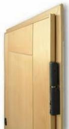
Esta dobradiça permite a ajustagem da porta em altura. O seu eixo assenta sobre um sistema de esfera que permite uma maior suavidade no seu funcionamento.
